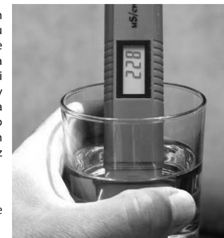
Slika3. Primer merjenja prevodnosti vode
