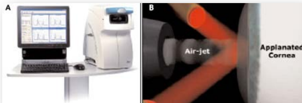
Slika 6 A: Aparat Ocular Response Analyzer, B: Pulz zraka, ki splošči roženico, po ukinitvi se roženica prek aplanacije navzven vrne v prvotno lego (vir: http://tradomed-invest.ru/Clinique/clin14/?template=26 ).
