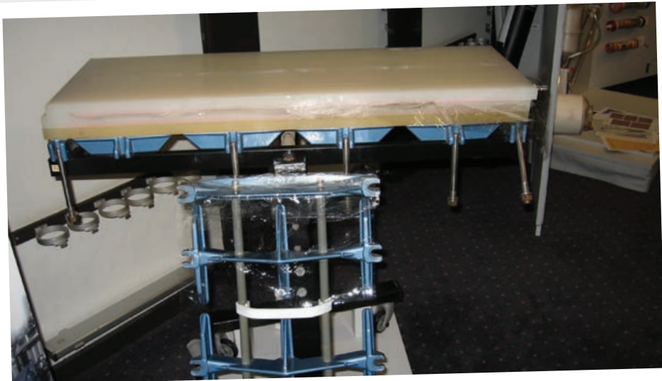
Plate dialyzer po Frederiku Kiilu, 1960
